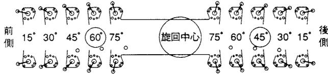
(3)右表に示す枠「黒色■」のアウトリガ張出角度の作業は禁止します。
